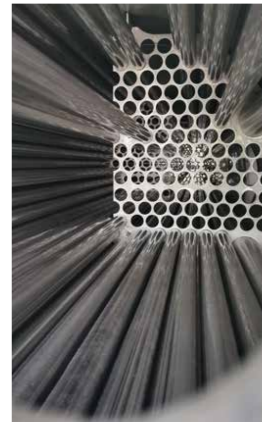
Der Röhrenfallfilmverdampfer basiert auf dem Prinzip eines Rohrbündelwärmetauschers © GIG Karasek
