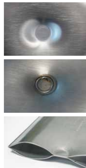
Oben: Punktgeschweißte Lamelle Mitte: Lasergeschweißte Lamelle Unten: Lamellenquerschnitt © GIG Karasek
