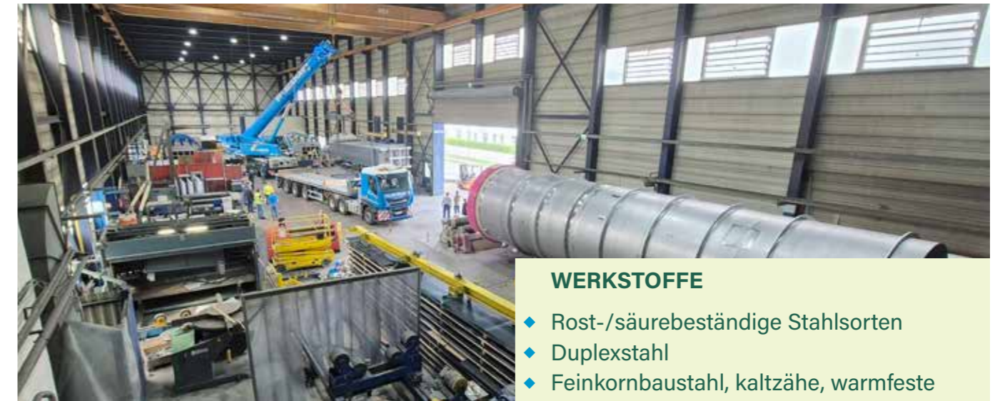
In Gloggnitz können Zylinder mit einem Durchmesser von bis zu 4300 mm hergestellt werden. © GIG Karasek
